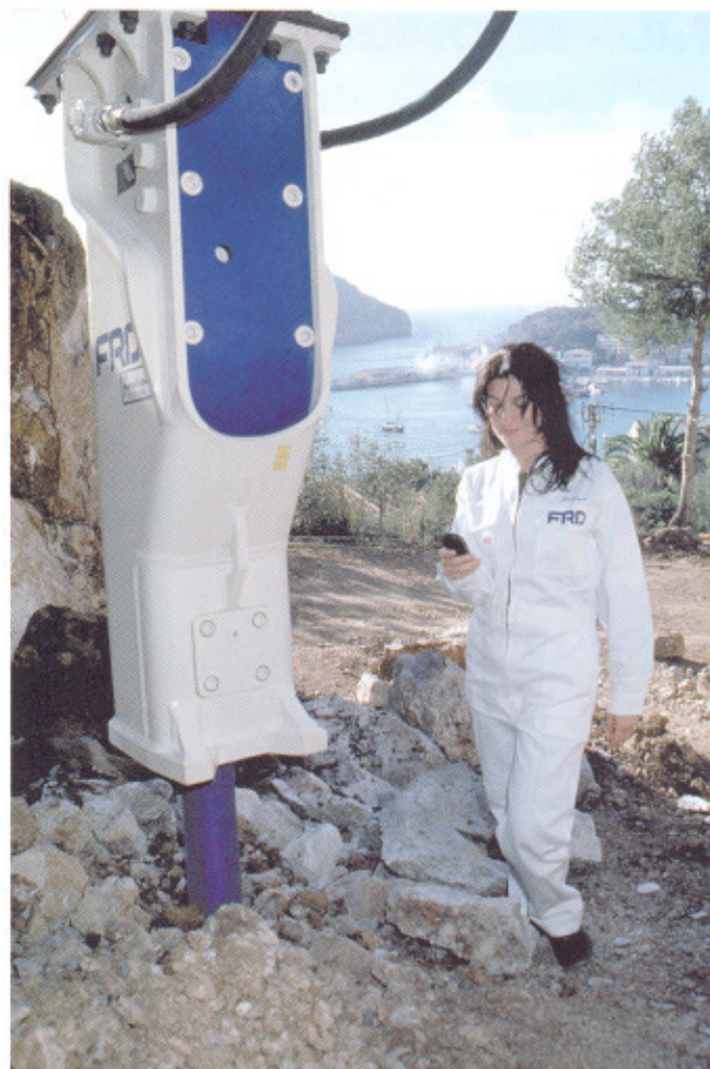
Støjmåling LN-ramme (lyddæmpet)
